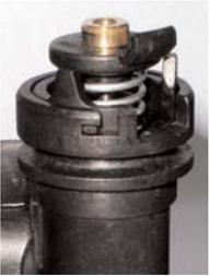
En el momento de una **extracción sanitaria**, el clapete móvil se desplaza hasta obstruir el conducto de retorno calefacción, pero acciona igualmente un **microswitch**, que permite el encendido del quemador.
